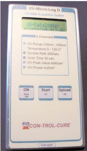
**UV-MICROLOG D AND UV-MICROLOG 6 RADIOMETER**
